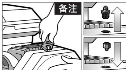
备注 拧开油脂嘴 (Nipple) 接合相应变径接头
