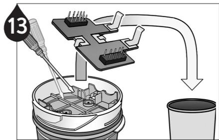
13 用螺丝刀 (-) 取出PCB线路板
