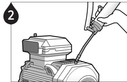
2 如管路被堵请用黄油枪打通管路
