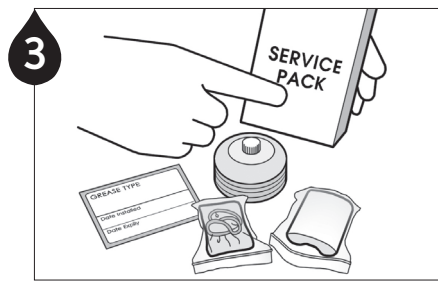
4 确认专用备件包容量及其构成品 (电池盒, 空油囊, 防尘罩, 标贴)
